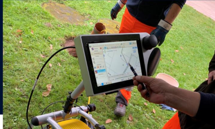
Mit einem IBAK-LISY-3-Satellitensystem zur lateralen Inspektion erfolgt die Inspektion und Aufzeichnung des Rohrverlaufs in nur einem Arbeitsschritt. Angeschlossen werden können alle kalibrierten 3D-fähigen Schiebekameras von IBAK. Das LISY-System ermöglicht Inspektionen von Anschlussleitungen ab DN 100. Der Vortrieb erfolgt wahlweise durch Spülen oder durch den Schiebepistol des LISY-Systems.
